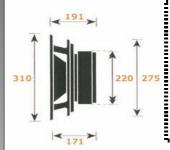
L' SW 320 è un subwoofer progettato per suonare in volumi piuttosto ridotti. Il cono è in cellulosa, la sospensione in gomma, il generoso magnete in ferrite è costituito da un doppio anello da 220 mm di diametro, la bobina mobile, avvolta su supporto in Kapton, è da 100mm. Queste doti costruttive insieme all'equilibrio dei parametri, danno all' SW 320 una risposta profonda e articolata unita a notevoli doti di velocita' e naturalezza
