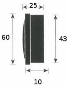
Il TW 25 FL è il nostro tweeter top di gamma. La cupola è in seta trattata a profilo catenario, magnete al neodimio, ferrofluido, la flangia ha dimensioni tali da ottimizzare il baffle (particolare spesso trascurato in auto), la griglia ad ampi fori esagonali ha una trasparenza del 74%. La cura in tutti i particolari costruttivi è restituita nella riproduzione musicale con un naturale micro-dettaglio e una linearità esemplare.
