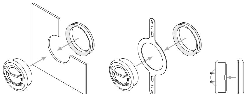
Lo speciale "V-ring" in dotazione rende veloce e sicuro il fissaggio del tweeter.
