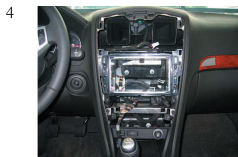
Place the 2 - Din metal bracket.
