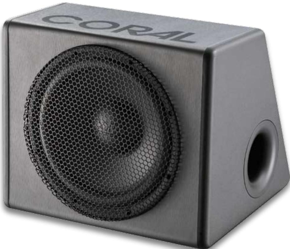
Il subwoofer **HDB 10** fornisce bassi molto profondi e ben controllati, con elevata dinamica e distorsione ridottissima. Il cono in polipropilene è rigido, leggero ed impermeabile. La bobina mobile multi strato è avvolta su un supporto rinforzato con resine particolarmente resistenti al calore: questa tecnologia assicura una elevata tenuta in potenza e notevoli escursioni, lineari e molto veloci.
