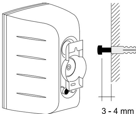
Per fissare il diffusore al muro: piazzate un tassello; inserite sul retro del box la staffa ed i relativi accessori; avvitate la vite, senza serrarla; scegliete la giusta posizione della staffa e serrate saldamente; agganciate la staffa al tassello.
