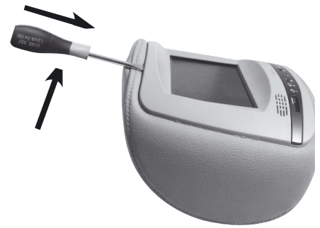
INSERIMENTO CACCIAVITE A TESTA PIATTA INSERTING THE FLAT SCREW-DRIVER INSERTION DU TOURNEVIS AYANT LA TÊTE PLATE SCHRAUBENZIEHER (MIT FLACHEM KOPF) ANLEGEN. INTRODUCCIÓN DE UN DESTORNILLADOR CON CABEZA PLANA
