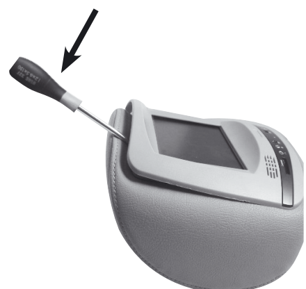
FARE LEVA VERSO IL BASSO LIFT, BY PRESSING DOWNWARDS. FAIRE LEVIER VERS LE BAS. NACH UNTEN DRÜCKEN UND AUSHEBELN. HACER LEVA HACIA ABAJO
