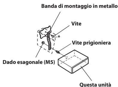
\* Per la vite\*, procurarsi una vite adatta all'ubicazione di installazione nel telaio.
