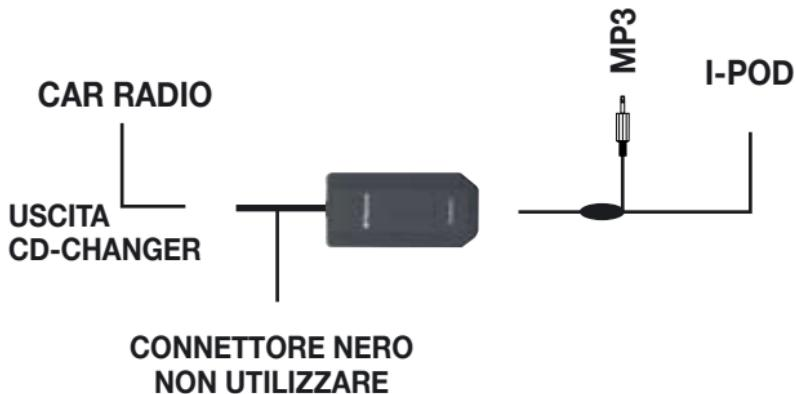
**SCHEMA DI INSTALLAZIONE PER SISTEMI
