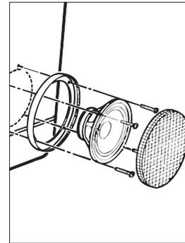
**I** - Tracciare e praticare un foro sul pannello portiera in corrispondenza dell'altoparlante. Effettuare i collegamenti e fissare l'altoparlante mediante le viti fornite in dotazione. Facendo pressione ai lati incastrare la griglia di protezione.
