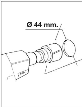
**I** - Tracciare e praticare un foro sul pannello per l'installazione del tweeter.
