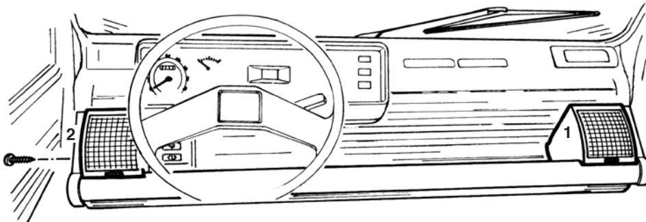
Dopo aver passato il cavo dell'altoparlante sotto il rivestimento del cruscotto ed averlo portato all'autoradio, inserire a pressione il box (1) facendolo aderire il più possibile al supporto porta oggetti in plastica (2). Forare con una punta di 2,5 mm., sia il supporto in plastica (2) sia il box (1) ed avvitare, con la vite in dotazione, il box al supporto.
