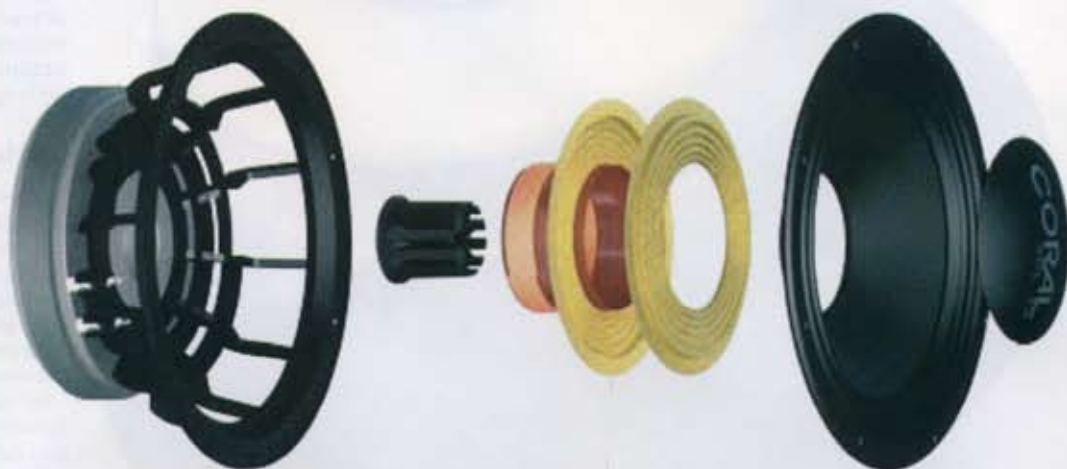
L'esplosione del Coral XPL 12 mostra i componenti principali dell'altoparlante. Notare l'originale dissipatore lamellare nero ed i centratori contrapposti ad ondulazione progressiva.
