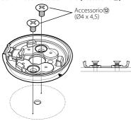
L'installazione è possibile anche usando un nastro biadesivo (accessorio(13))
