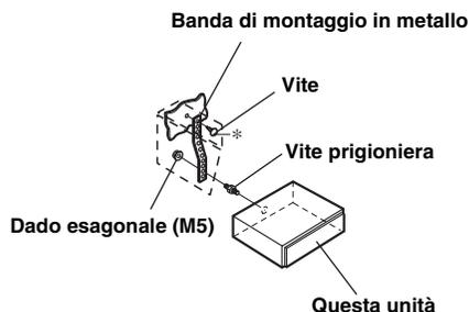
Se il veicolo è dotato di staffa, montare il bullone esagonale lungo sul pannello posteriore del CDE-101R/CDE-101RM/CDE-102Ri/CDE-103BT/CDE-104BTi e applicare il cappuccio di gomma sul bullone esagonale. Se il veicolo non è dotato del supporto di montaggio, rinforzare l'unità principale con la banda di montaggio in metallo (non in dotazione). Collegare tutti i cavi del CDE-101R/CDE-101RM/CDE-102Ri/CDE-103BT/CDE-104BTi secondo le istruzioni dettagliate riportate nella sezione COLLEGAMENTI.
