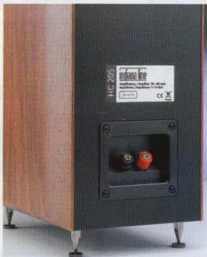
*La morsettiera di collegamento non consente la biamplificazione, e il mobile poggia su delle punte e contropunte metalliche di ottima fattura e finitura necessarie per tenere il diffusore rialzato dal piano d'appoggio e non ostruire l'emissione del condotto reflex, oltre che per migliorare l'accoppiamento tra il diffusore e il piano stesso.*
