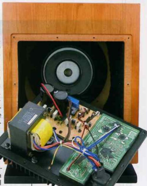
**L'amplificatore da 150 W rms consente livelli di emissione adeguati senza compressioni particolari.**
