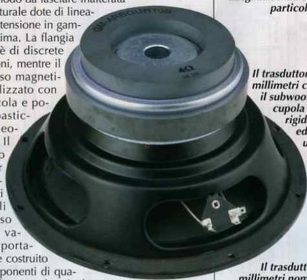
**Il trasduttore da 260 millimetri che equipaggia il subwoofer ha la cupola parapolvere rigida e rovesciata ed è dotato di una buona linearità a grandi escursioni.**
