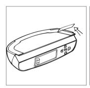
Asportare la protezione del bi-adesivo dal supporto ricevitore/display.
