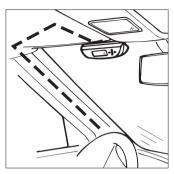
Posizionare il ricevitore nel punto desiderato per stabilire dove dovrà uscire il cavo alimentazione.
