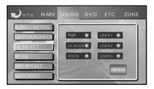
È possibile selezionare le 3 equalizzazioni di base (POP, CLASSIC, ROCK) premendo le relative icone. È inoltre possibile selezionare le 3 modalità utente per l'equalizzatore.
